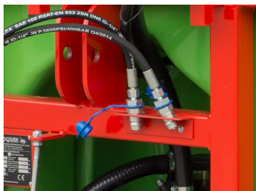
Rysunek 2 Przewody hydrauliczne umocowane prawidłowo.
